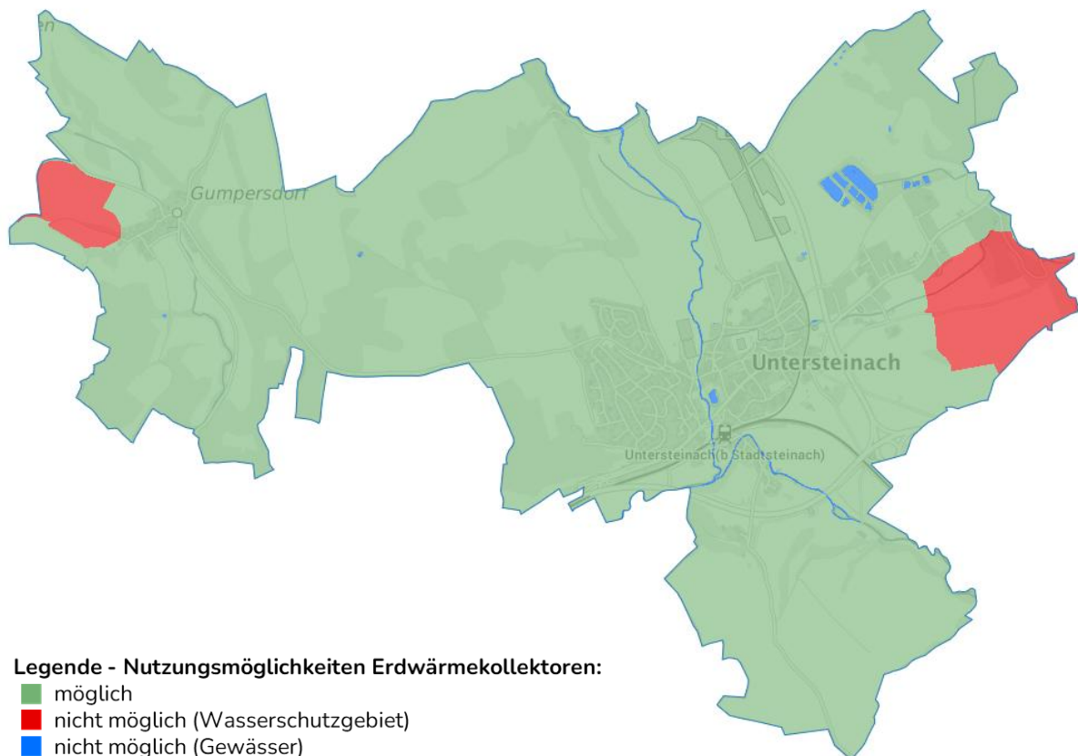
Abbildung 28: Nutzungsmöglichkeiten von Erdwärmekollektoren [9] [29]
